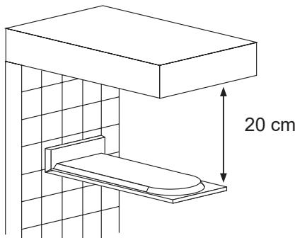
Damit Sie sich bei der Installation der Kopfbrause sicher und bequem befinden, sollte die Dusche mindestens 20 cm von der Dusche entfernt sein. Oberhalb der oben genannten Parameter dienen nur als Referenz.
